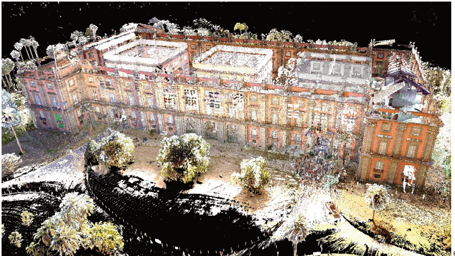
4,5_Viste 'da sotto in su' della nuvola dei punti (parziale), da rilievo range-based (TLS). 6_Nuvola dei punti delle pareti esterne e sulle tre corti da rilievo range-based (TLS), vista da est.
