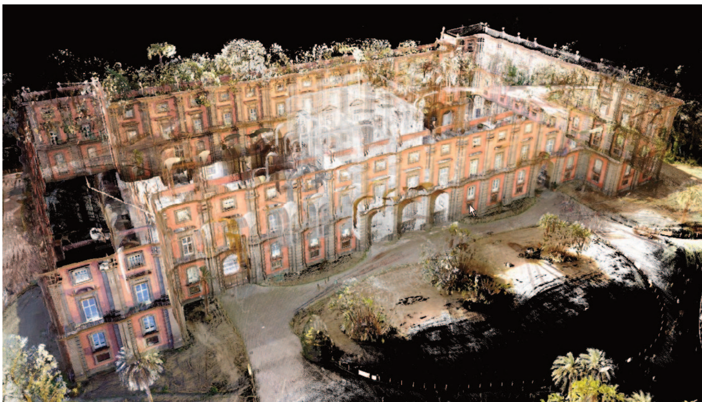
1_Veduta aerea. 2_Fotografia del fronte nord-est. 3_Nuvola dei punti delle pareti esterne, da rilievo range-based (TLS), vista da est.
