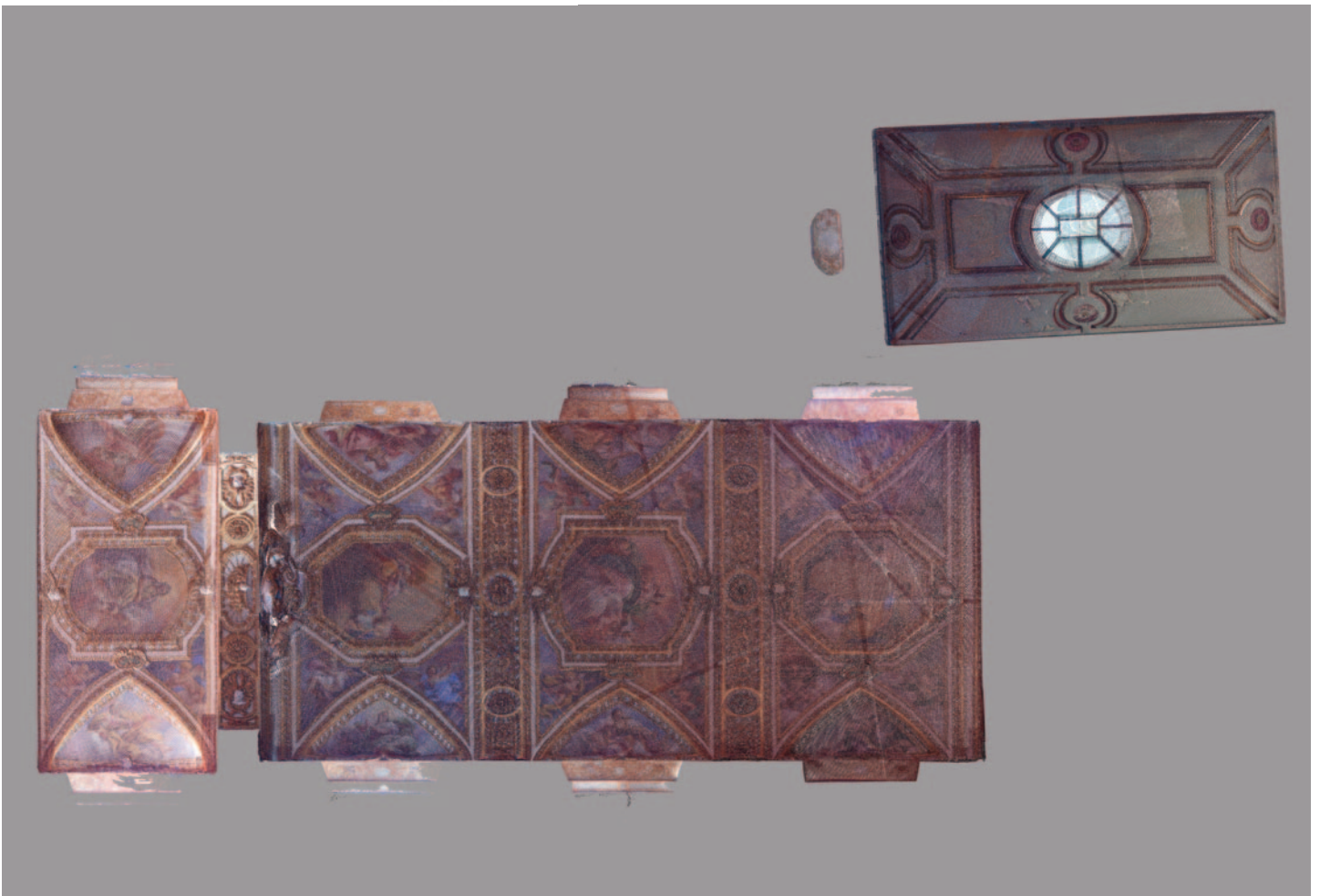
14_Sezione assonometrica 'in trasparenza' da nuvola dei punti range-based (TLS). 15_Vista prospettica da nuvola dei punti range-based (TLS). 16_Ortoproiezione ipografica 'in trasparenza' da nuvola dei punti range-based (TLS).
